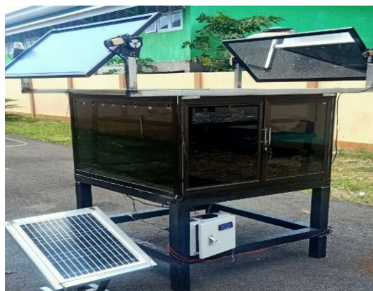
Gambar 2. Pengeringan dengan Alat Pengering System Rumah Kaca
