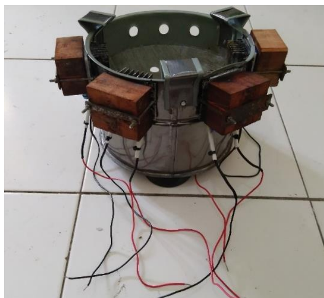
Gambar 4. Prototipe tungku dengan Modul TE
