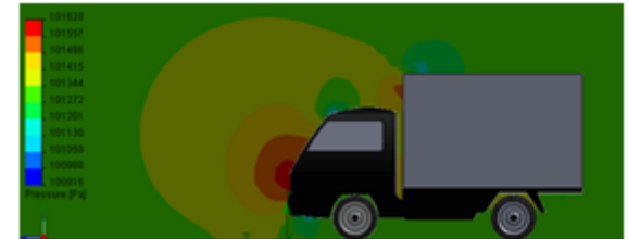
Gambar 7. Distribusi tekanan mobil box X pada 80 km/jam aliran angin yang seragam
