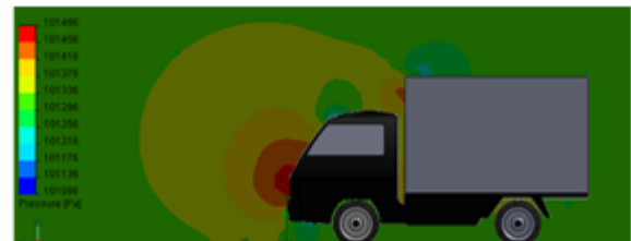
Gambar 6. Distribusi tekanan mobil box X pada 60 km/jam aliran angin yang seragam
