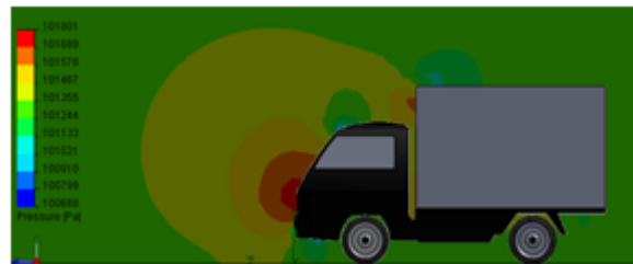
Gambar 8. Distribusi tekanan mobil box X pada 100 km/jam aliran angin yang seragam
