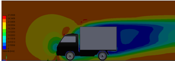
Sumber: data olahan Gambar 10. Distribusi kecepatan 80 km/jam pada mobil box X
