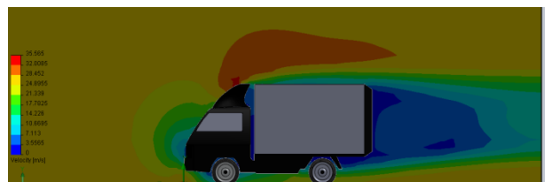
Sumber: data olahan Gambar 17. Distribusi kecepatan 100 km/jam pada mobil box Y
