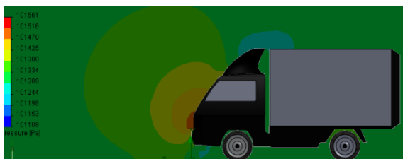
Sumber: data olahan Gambar 12. Distribusi tekanan mobil box Y pada 60 km/jam aliran angin yang seragam
