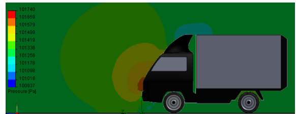
Sumber: data olahan Gambar 13. Distribusi tekanan mobil box Y pada 80 km/jam aliran angin yang seragam
