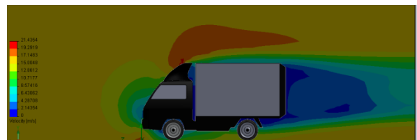
Sumber: data olahan Gambar 15. Distribusi kecepatan 60 km/jam pada mobil box Y
