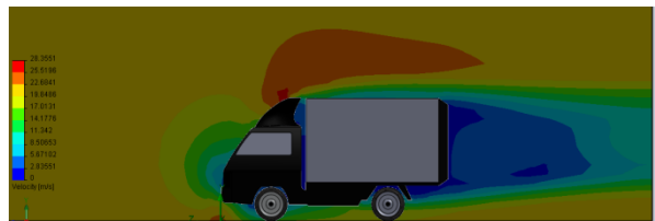
Sumber: data olahan Gambar 16. Distribusi kecepatan 80 km/jam pada mobil box Y
