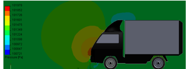
Sumber: data olahan Gambar 14. Distribusi tekanan mobil box Y pada 100 km/jam aliran angin yang seragam
