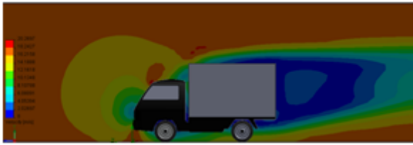
Sumber: data olahan Gambar 9. Distribusi kecepatan 60 km/jam pada mobil box X
