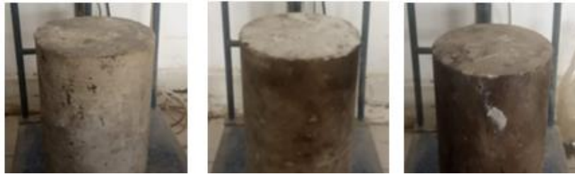
Gambar 3 Kondisi Beton Pasca 1 jam, 2 jam dan 4 Jam Pembakaran
