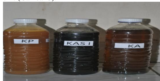
Gambar 2. Limbah cair pabrik kelapa sawit kolam pengasaman (KP), kolam anaerob sekunder I (KAS I) dan kolam aerob (KA)
