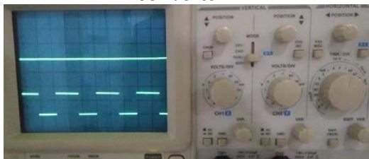
Gambar 25 Bentuk atau Besar sinyal PWM 50% dan Keluaran Boost converter
