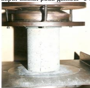
Gambar 1 Pengujian kuat tekan beton
