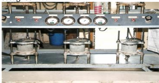
Gambar 4 Pengujian permeabilitas beton
