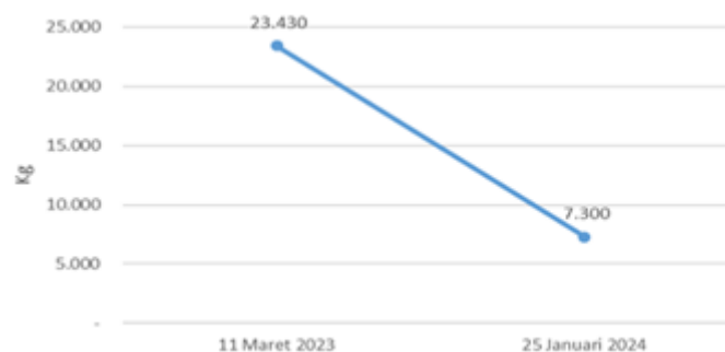
Gambar 13 Grafik Penurunan Endapan OST No. 1 dari Sebelum Modifikasi dan Stelah Modifikasi Pipa Inlet OST No. 1
