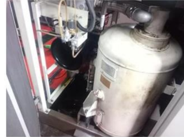
Gambar 7 Kebocoran Filter Oli
