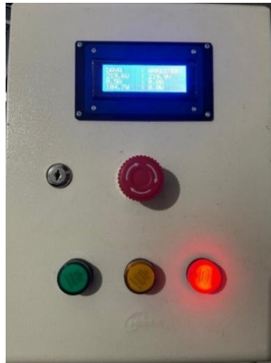
Gambar 10 Pilot Lamp Merah Menyala dan Proteksi Aktif
