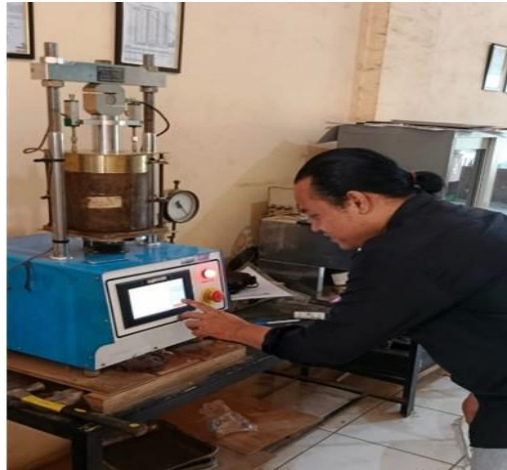
Gambar 2 Pengujian CBR Laboratorium
